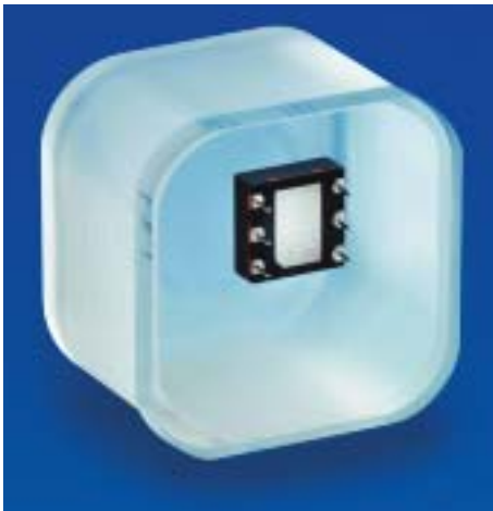
Eingekapselter Temperatur-Feuchte-Sensor mit Dimensionen von 10 mm x 10 mm x 10 mm, direkt kontaktiert über sechs Wolfram-Durchführungen
